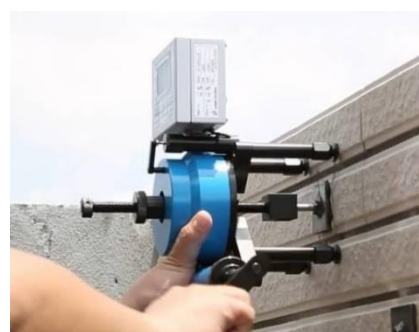
照片 2.3.5 拉拔試驗
