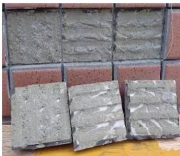
圖 5 接著強度平均 2.10 N/mm<sup>2</sup> 皆為內聚破壞
