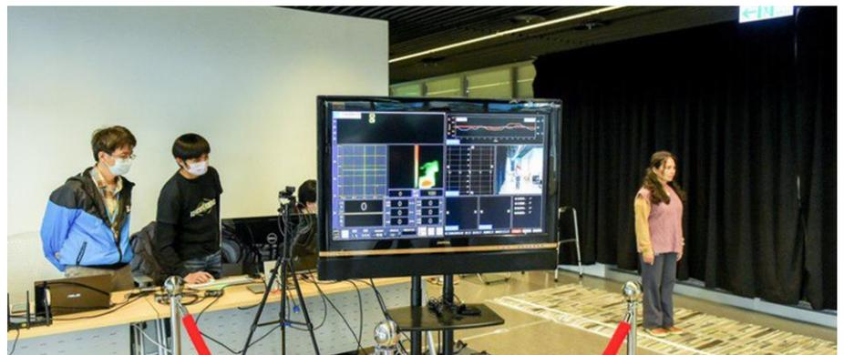
工研院開發「全身步態測試系統」，結合「智慧地墊」與「肢體骨架動態分析系統」，評估異常步態風險等級、異常部位分析，協助銀髮族重新邁出人生的步伐。
