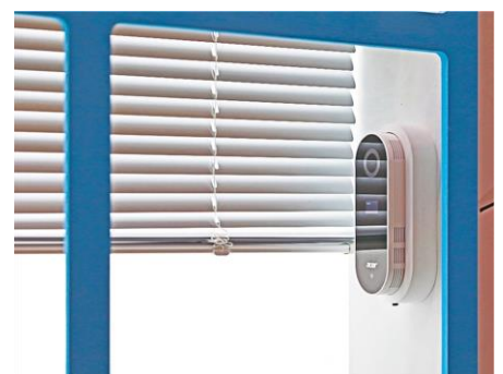
萬物物聯網，窗簾也加入市場，當日照光線的照射程度愈來愈高，智慧裝置偵測器會感應環境照度，連動歐加 E-BOX 主機拉起窗簾開啟智慧遮陽模式。
