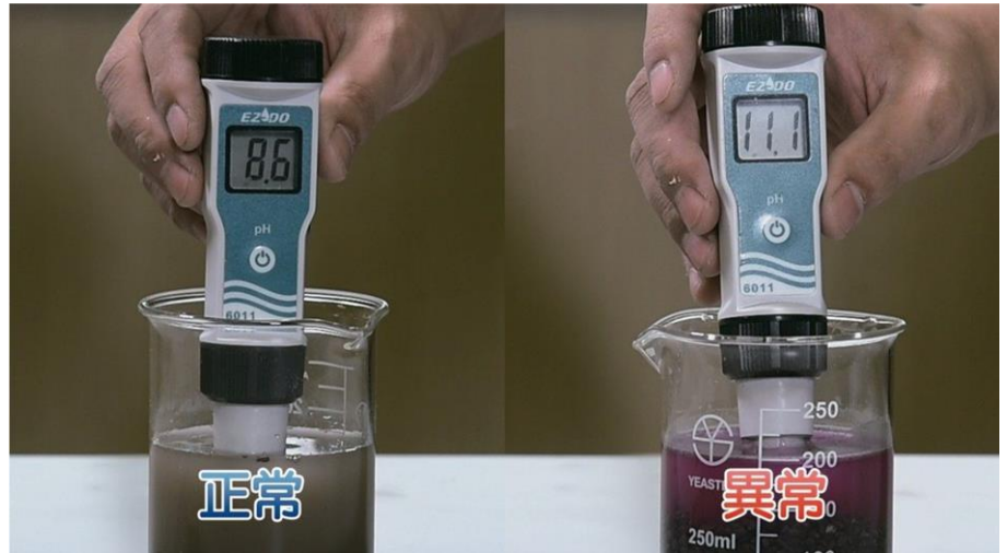
經過酸鹼值試驗，pH 值大於 10，砂石原料就可能受到劣質爐渣汙染。圖片戴雲發提供
