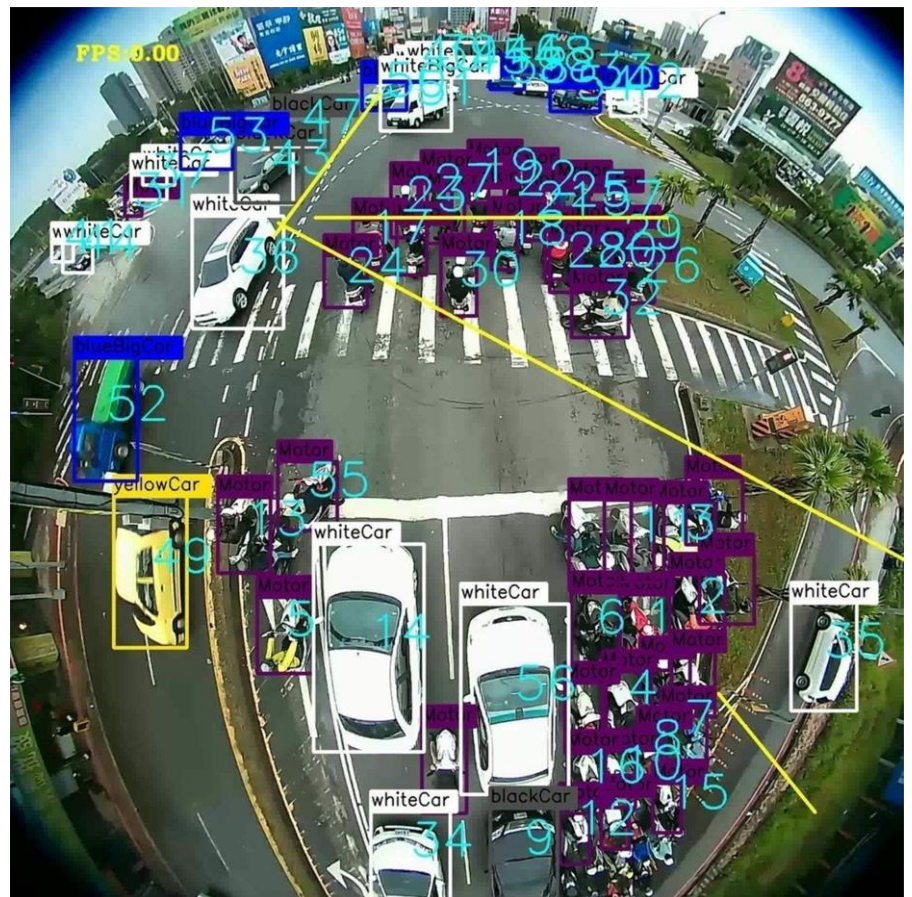
藉由「魚眼攝影機 AI 之車流技術」不僅讓系統準確度提高，計算效能上也大幅提升，並且能在 low power 的 GPU 晶片上執行即時辨識。圖/國立海洋大學提供
